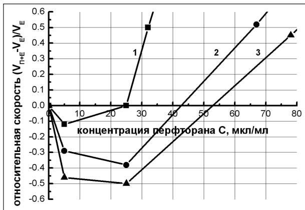
Рис. 3. Зависимость относительной скорости от концентрации добавленного перфторана для одного (кривая 1), двух монополярных (кривая 2) и для двух разнополярных (кривая 3) импульсов электрического поля.
